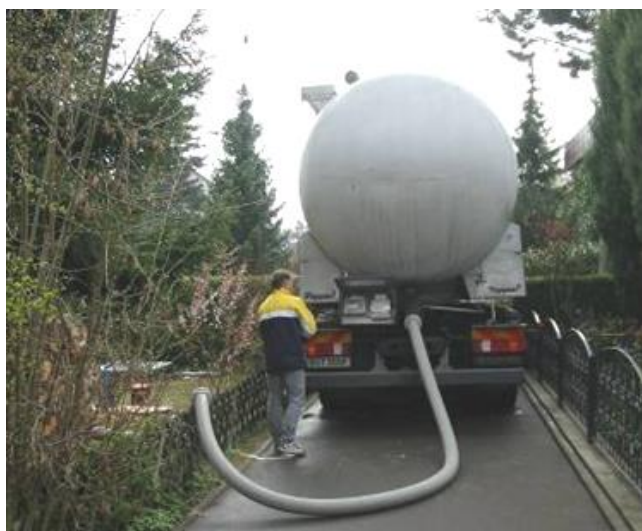
Sl. 5-32 Način punjenja spremnika peleta [Froling]
